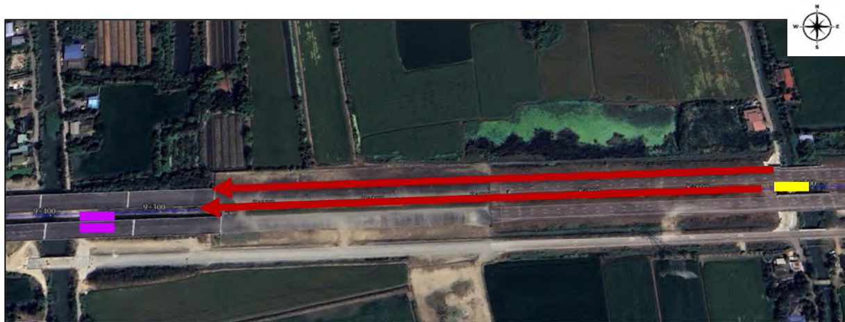
รูปที่ 7.2-7 การปรับปรุงทิศทางการระบายน้ำบริเวณเกาะกลางทางหลวงพิเศษระหว่างเมืองหมายเลข 81 ไปยังคลองบางอีลิ (กม.9+400)
