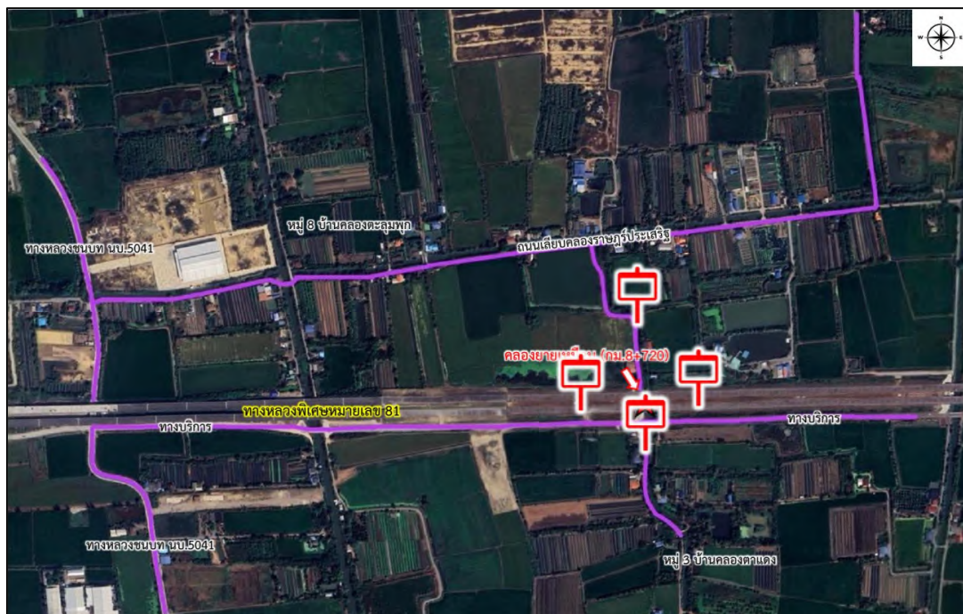
★ สะพานข้ามคลองยายเหมือน เส้นทางการเดินทางเข้าสู่ทางลอดใต้สะพาน □ ตำแหน่งติดตั้งป้ายเตือน “ระวังน้ำท่วม” รูปที่ 5.2.6-15 ตำแหน่งติดตั้งป้ายเตือนให้ระวังน้ำท่วม ก่อนเดินทางเข้าสู่ทางลอดใต้สะพานข้ามคลองยายเหมือน (กม.8+720)
