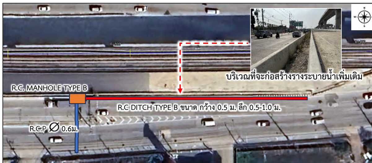
รูปที่ 5.2.6-21 รูปแบบการแก้ไขปัญหการระบายน้ำบริเวณเชิงลาดสะพานทางขึ้นทางพิเศษ จากทางหลวงหมายเลข 302
