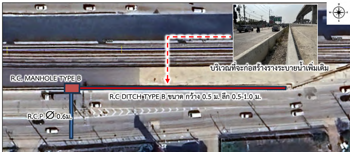
รูปที่ 7.2-10 รูปแบบการแก้ไขปัญหาระบายน้ำบริเวณเชิงลาดสะพานทางขึ้นทางหลวงพิเศษ จากทางหลวงหมายเลข 302 (ถนนรัตนธิเบศร์)
