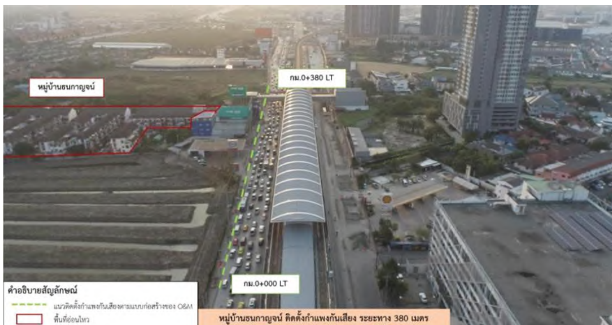
รูปที่ 5.2.2-4 ตำแหน่งติดตั้งกำแพงกันเสียงถาวร บริเวณหมู่บ้านธนกาญจน์
